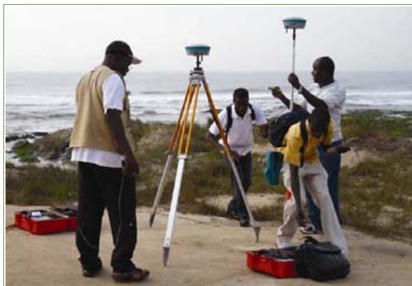
利用高精度全球定位系统进行海滩测绘分析，监测海岸侵蚀情况
