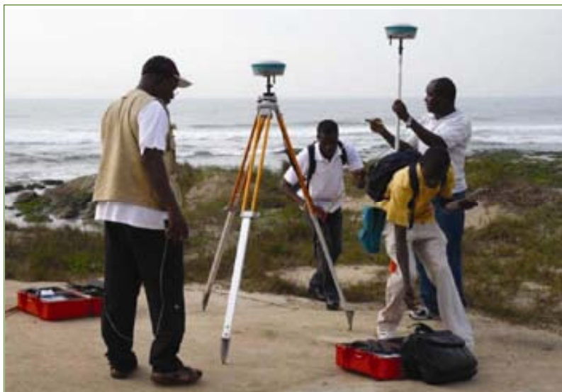
Составление берегового профиля с использованием высокоточной системы глобального позиционирования в целях мониторинга эрозии прибрежных почв
