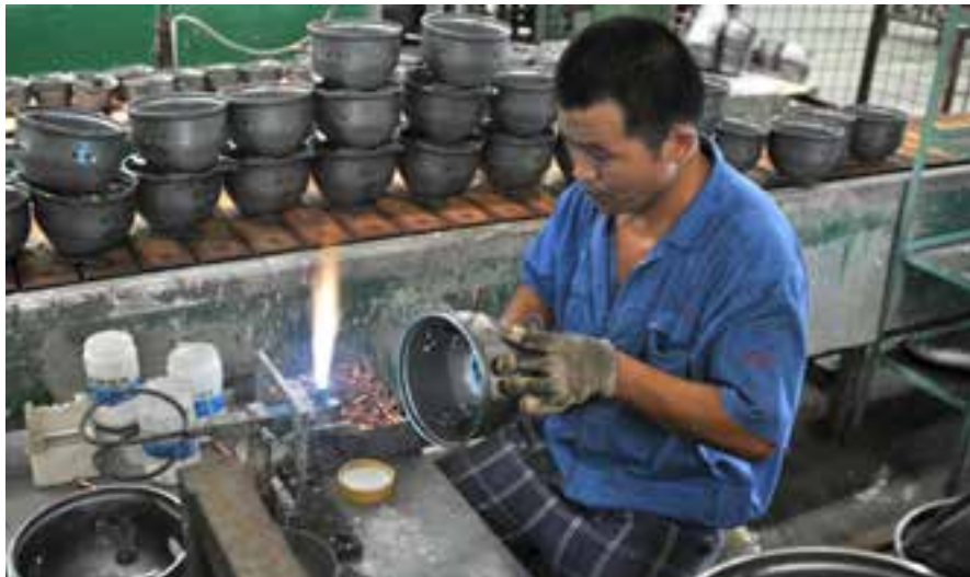
中国湖北省冰箱生产公司。氯氟烃 12 已被天然制冷剂碳氢化合物所替代，后者的商业名称为 R600a（异丁烷）和 R290（丙烷）。由于这些气体易燃，工发组织专门为操作人员举办了培训班，以确保安全、有效地使用这些新的制冷剂。
