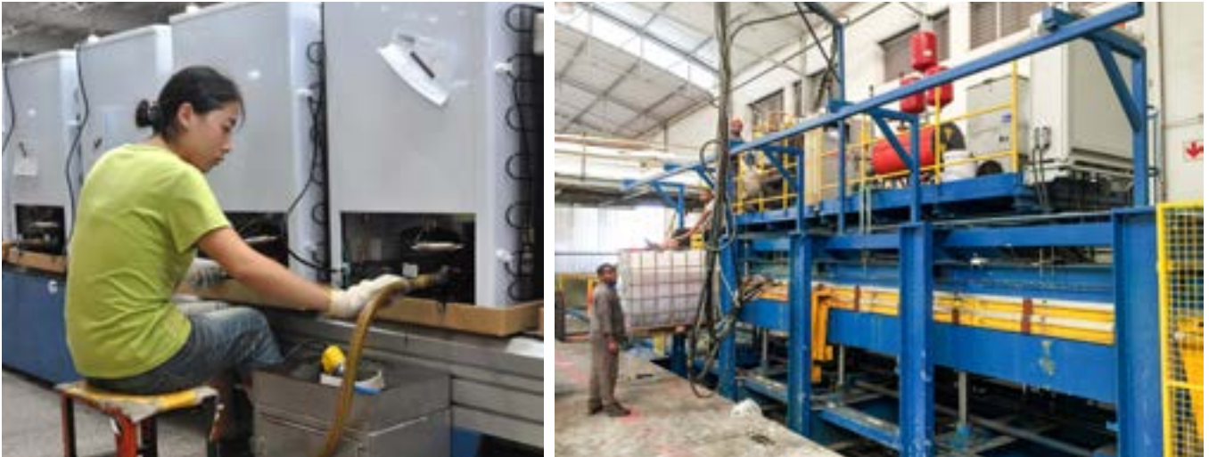
Izquierda: Empresa productora de compresores para refrigeración en la provincia de Hubei, China. Estos compresores utilizan nuevos refrigerantes de hidrocarburo, como el R-600 o el R-290. Además de proteger la capa de ozono y de tener un bajo potencial de calentamiento del planeta, ofrecen una mayor eficiencia energética que los compresores que usaban el CFC-12 u otros refrigerantes alternativos, como el R-134a y el R-404a. Derecha: Proyecto de demostración del Protocolo de Montreal en Sudáfrica sobre las ventajas técnicas y económicas de la inyección al vacío de espuma plástica en el aislamiento de paneles de paredes discontinuas.
